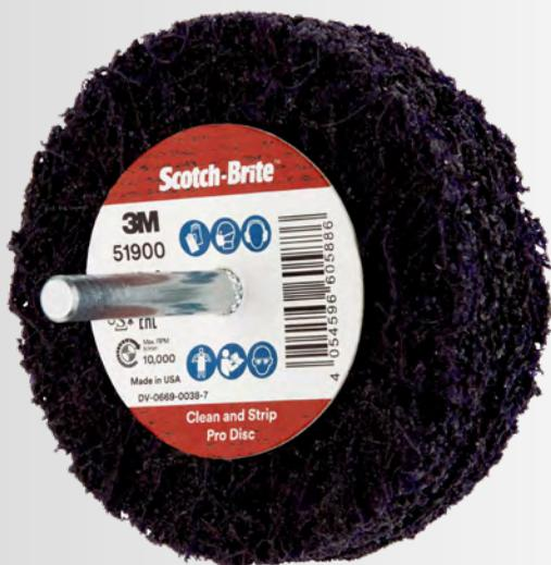
La struttura aperta in nylon del disco Scotch-Brite™ Roloc™ Clean and Strip XT Pro è dotata di minerale abrasivo in carburo di silicio fine. Rimuove efficacemente ruggine, vernice, calamina leggera, rivestimenti e adesivi dalle superfici senza alterare in modo significativo il supporto. Le fibre ad alta resistenza sono altamente conformabili, resistono alle sollecitazioni e all'intasamento e garantiscono buone prestazioni sui bordi del pezzo in lavorazione.
