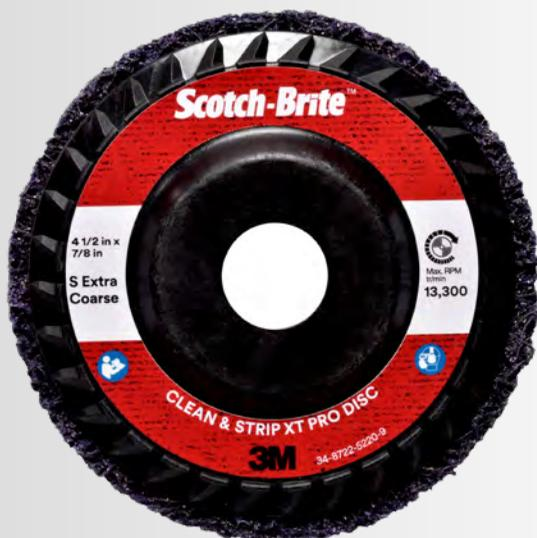
La struttura aperta in nylon del disco Scotch-Brite™ Clean and Strip XT Pro è dotata di minerale abrasivo in carburo di silicio fine. I nostri dischi rimuovono efficacemente ruggine, vernice, calamina, rivestimenti e adesivi dalle superfici senza alterare in modo significativo il materiale di base.
