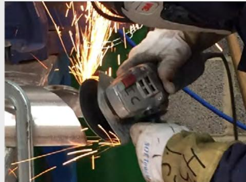
Preparazione saldatura - 3M™ Disco fibrato 987C/787C 60+
